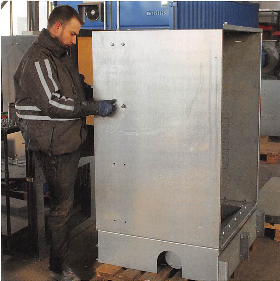
Montage d'un caisson de butte de tir avec, au centre, la plaque de blindage ondulée, fixée au panneau arrière. Celle-ci après 23000 impacts en bas.
