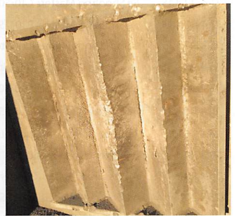
Montage d'un caisson de butte de tir avec, au centre, la plaque de blindage ondulée, fixée au panneau arrière. Celle-ci après 23000 impacts en bas.
