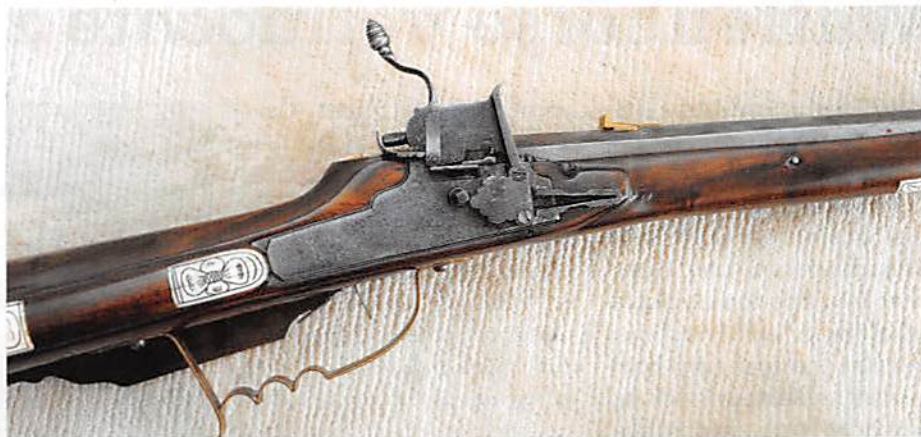
Schloss von aussen: Der Halter mit dem Schwefelkies liegt abgesenkt über der Pulverpfanne.
