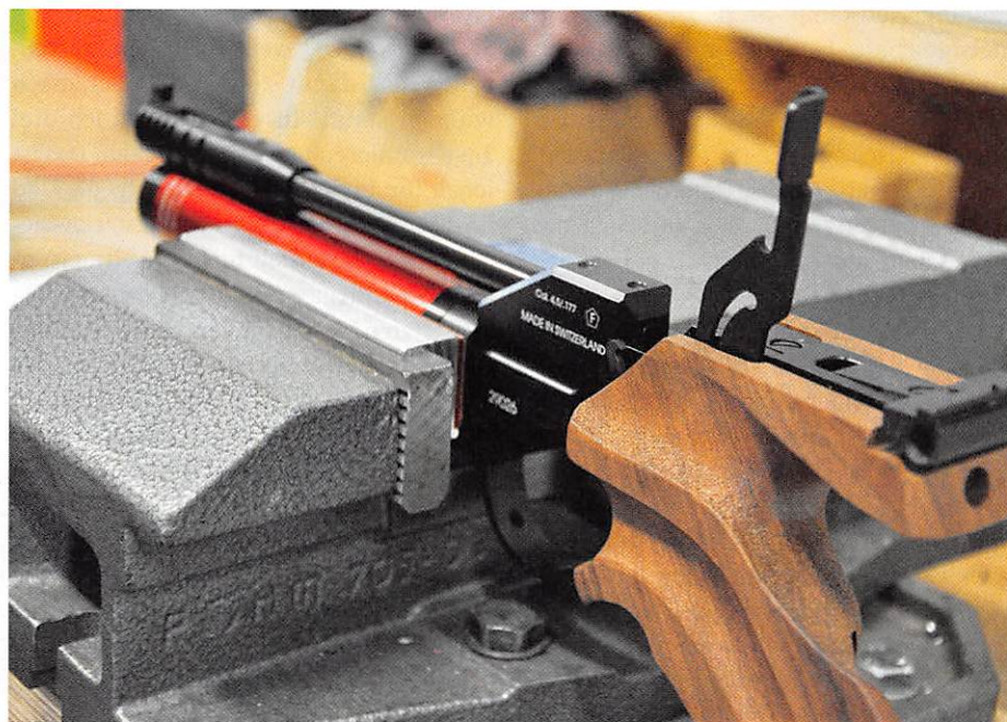
Die Testpistole der Marke Steyr ist zur Ermittlung des Schussbildes im Schraubstock eingespannt.
