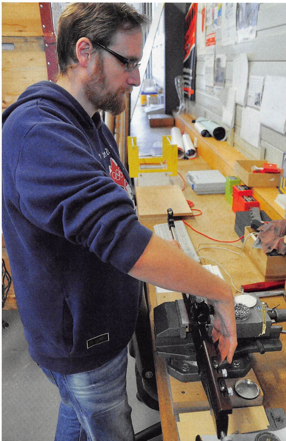
Marcel Ackermann spannt ein Luftgewehr in den Teststand ein.
