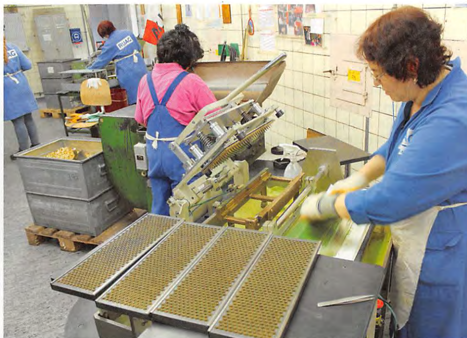
Frauen im Einsatz beim Einbringen des Zündsatzes und bei der Qualitätskontrolle (Bild unten).
