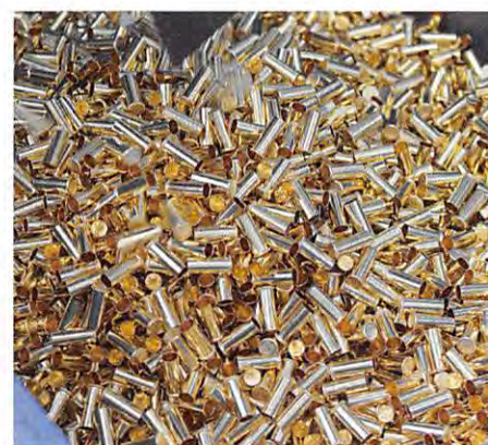
Die aus Bandmaterial gezogenen Patronenhülsen warten auf ihre Weiterverarbeitung (oben). Aus den Kupfer- oder Messingstangen (im Bild links) werden 9mm-Action-Geschosse gedreht, welche RWS ebenfalls herstellt.
