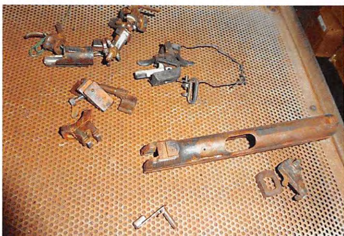
So sehen die zu brünierenden Teile nach dem erstmaligen «Rosten» aus.
