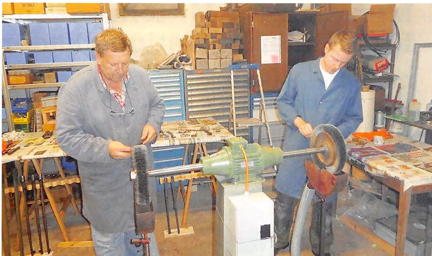
Vater und Sohn Rüegg beim «Kratzen». Die nach dem Anstreichen gerosteten Teile müssen mit einer speziellen Drahtbürste vom Rost befreit werden.
