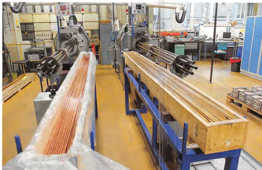
Die aus Bandmaterial gezogenen Patronenhülsen warten auf ihre Weiterverarbeitung (oben). Aus den Kupfer- oder Messingstangen (im Bild links) werden 9mm-Action-Geschosse gedreht, welche RWS ebenfalls herstellt.
