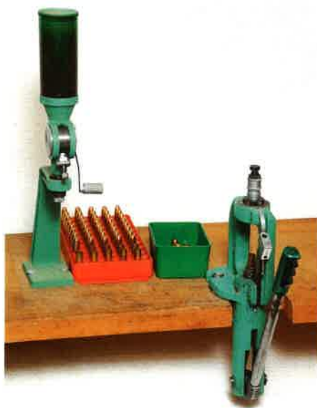
Dem Einsteiger genügt eine Einstationenpresse, auf welcher er viele Kurz- und Langwaffenpatronen wiederladen kann. Links das Pulverabfüllgerät, welches die genaue Pulvermenge volumetrisch dosiert.
