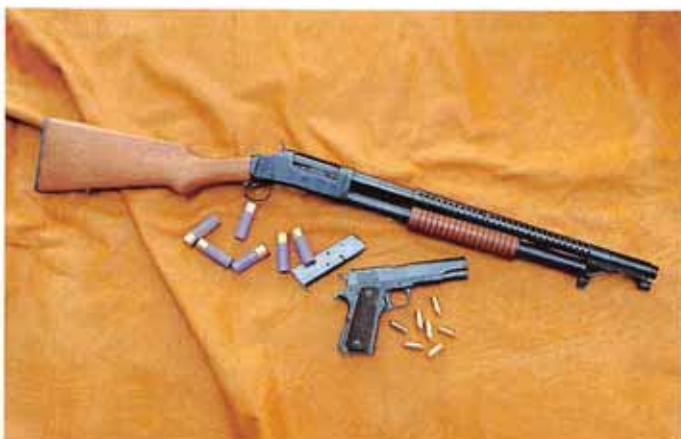
97-11: Norinco-Kopie der Winchester-Vorderschaft-Repetierflinte Modell 1897 im Kaliber 12/70, darunter eine Original Colt 1911 M1A1 im Kaliber .45 ACP.
