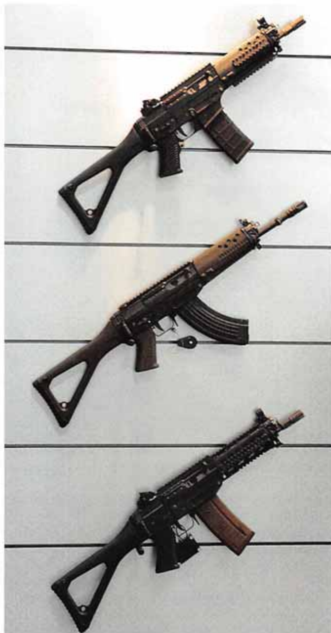
Das Modell SG 553 R von SAN Swiss Arms mit dem gekrümmten Magazin in der Bildmitte verwendet die Kalashnikow-Patrone 7,62x39 mm.
